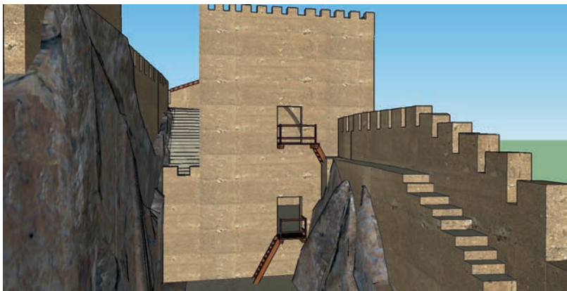
Fig. 7: Fachada norte del patio. Acceso en altura, núcleo de comunicaciones y relación con adarve este
