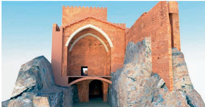
Fig. 6 Sección mirando al sur de nave de arcos diafragmáticos
